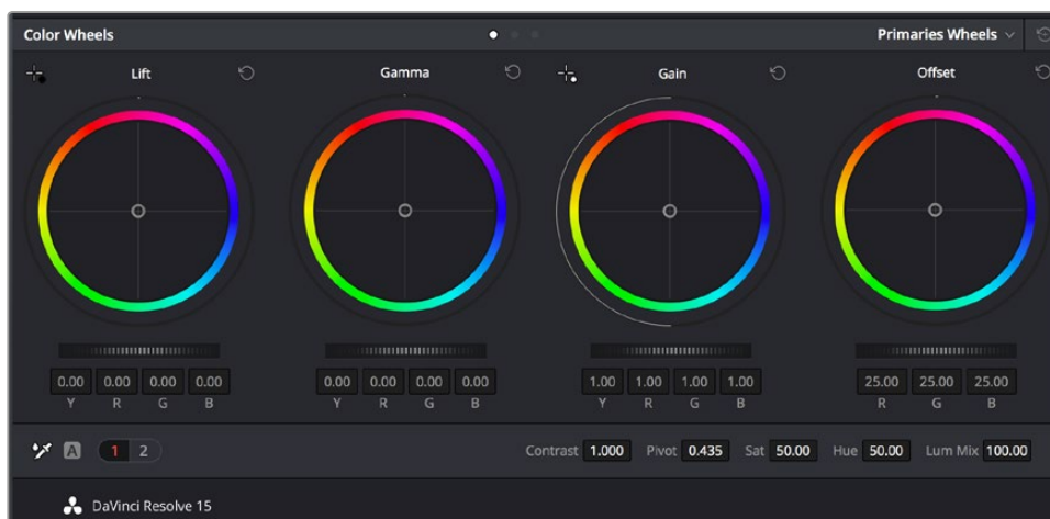
Круги Lift, Gamma, Gain и Offset предназначены для изменения параметров цвета и баланса тонов. Чтобы выполнить глобальную коррекцию всех цветов для каждой области, перетащите слайдер шкалы вперед или назад.
